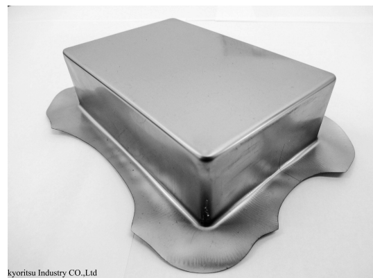
写真1 材質 SUS 304、板厚 0.1 mm の角絞り
