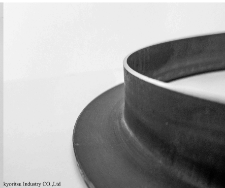
写真4 写真3を再度成形し、パンチ R=4Rにしたもの
