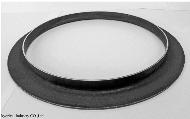
写真4 写真3を再度成形し、パンチ R=4Rにしたもの
