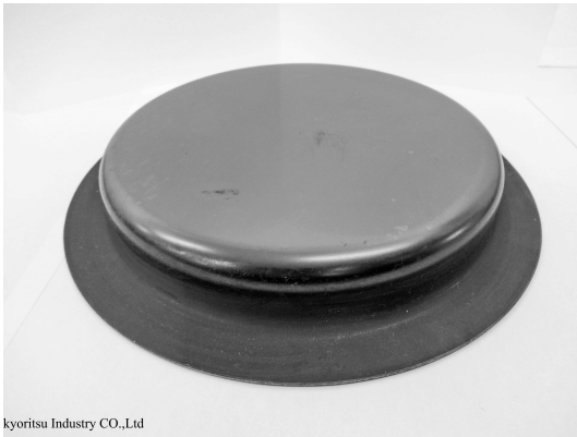
写真2 材質 SUS 440 C、板厚 1.6 mm の深絞り (外観)
